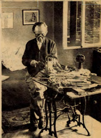
Rác Aladár és munkasztala: egy öreg varrógépből átalakított kismotoros hűsodrógép és a készülő cimbalomverők
